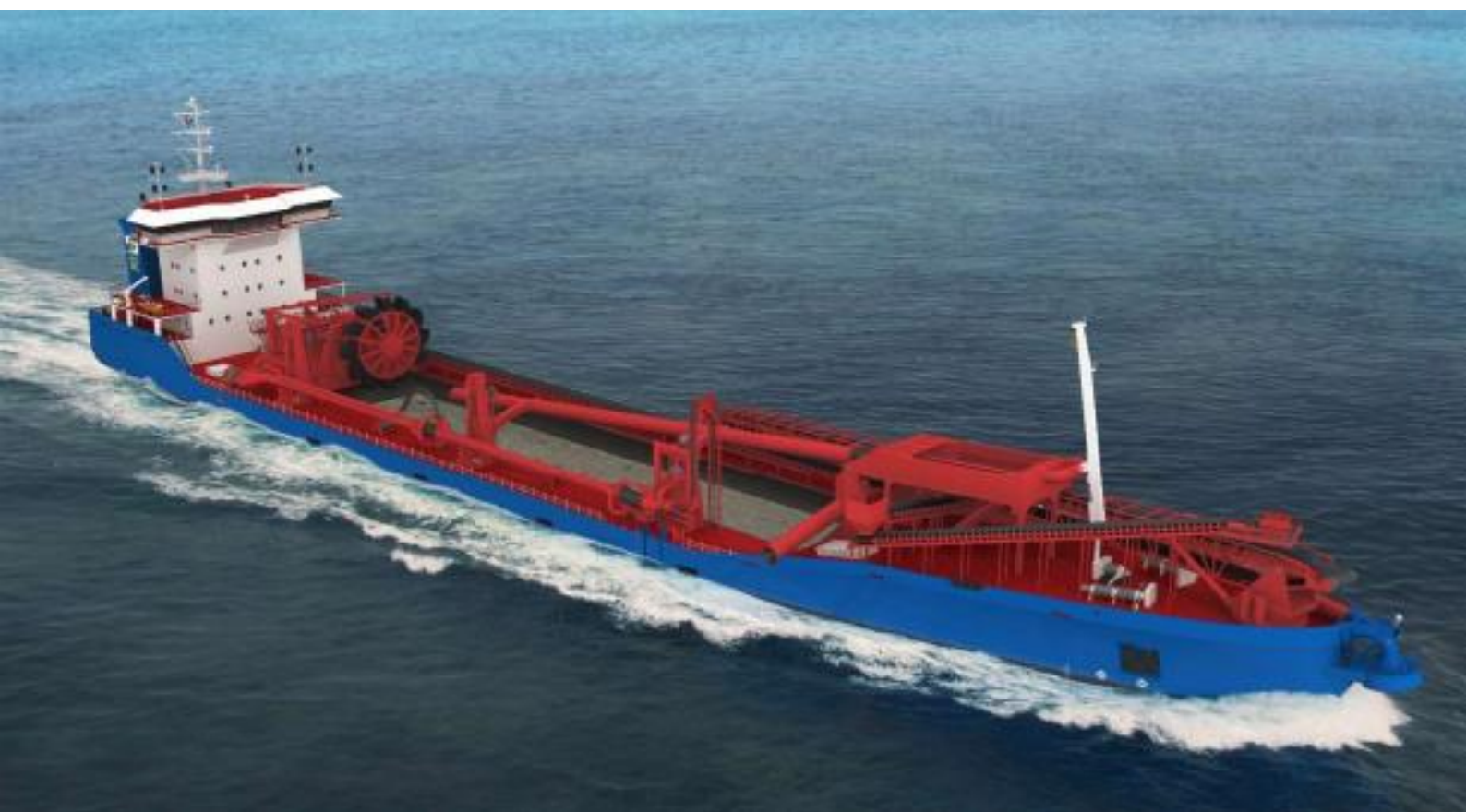
DC Dredging's schip de DC Orisant, het eerste diesel elektrisch aangedreven bagger vaartuig.
